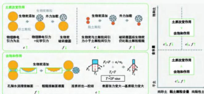
图5 生物炭对土体抗剪强度影响机理示意图
