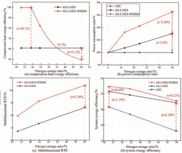
图5 (a) 压缩余热焓效率; (b) 功耗比; (c) 系统RTE; (d) 系统焓效率
