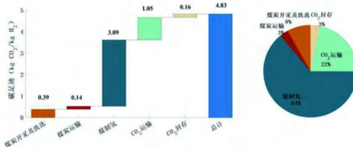
图2 煤制氢CCUS改造全流程碳足迹结构图
