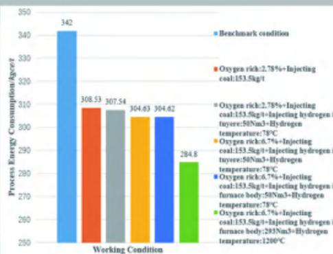
图2 不同富氢喷吹方式下的高炉理论极限能耗
