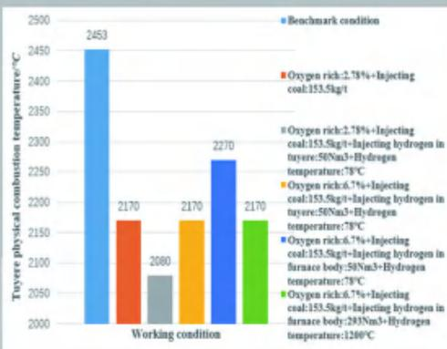
图1 不同富氢喷吹方式下的风口理论燃烧温度
