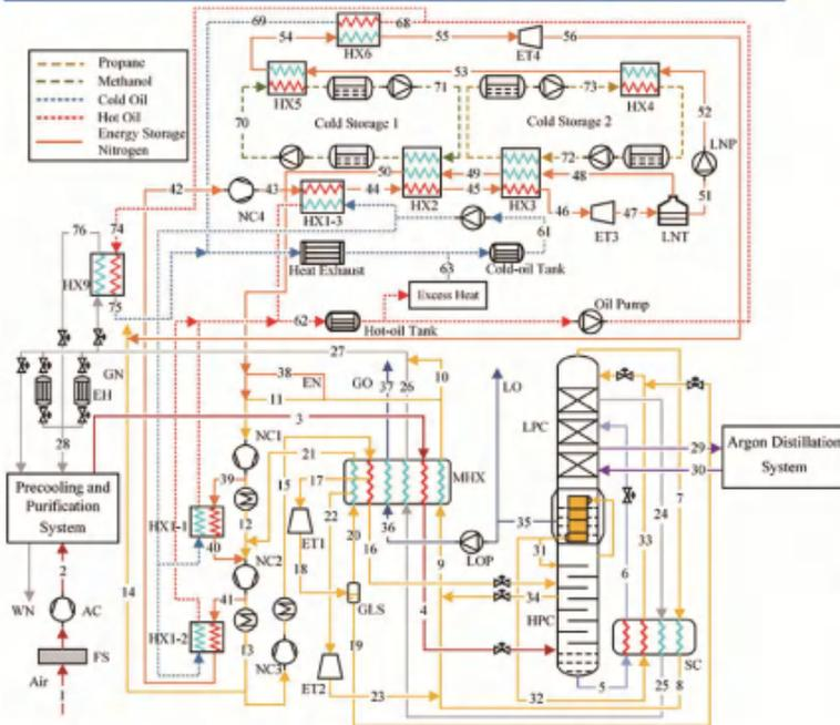
图1 AS-LNES-WHSM工艺流程图
