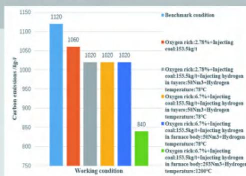
图3 不同富氢喷吹方式下的高炉理论碳排放量
