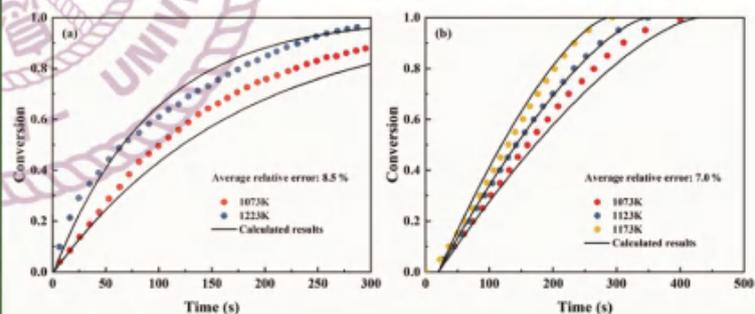
浓度的影响: 下图展示了不同CO浓度下两种 $\text{Fe}_2\text{O}_3$ 的反应动力学特性, 结果表明实验结果与模型结果具有良好的一致性, 该模型能够较好地描述浓度对载氧体反应特性的影响。
